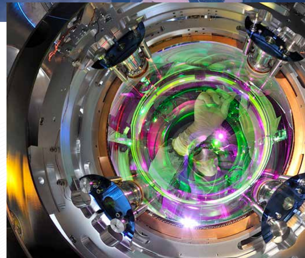
In basso a destra - mostra il retro di uno degli specchi di 42 kg del rivelatore. Uno scienziato sta liberando i blocchi di sicurezza utilizzati durante l'installazione - © Maurizio Perciballi / EGO.
